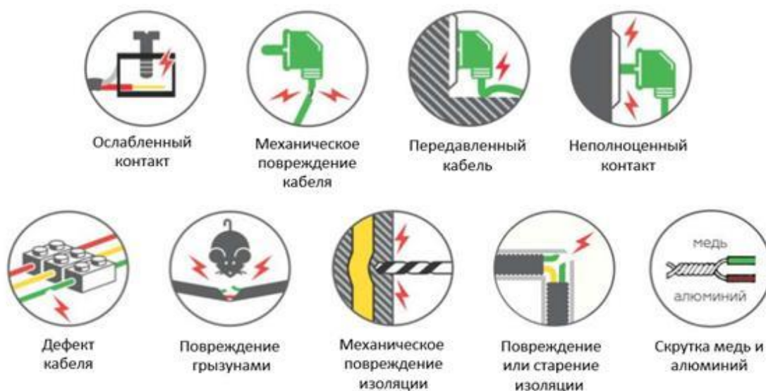
Рисунок 6. Возможные причины искрения в электропроводке
